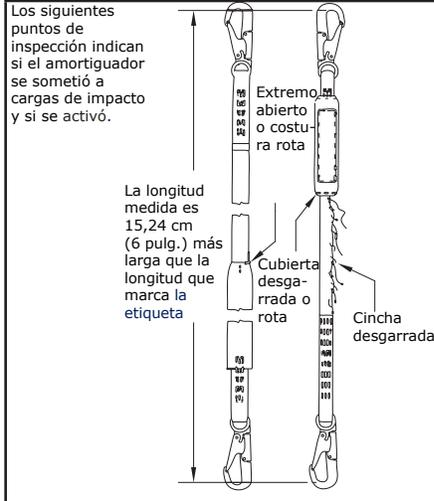
Inspeccione cada componente del sistema o cada sistema secundario según las instrucciones del fabricante asociado.
